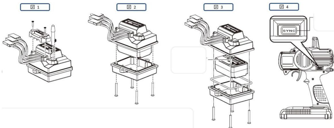
図 1 防水 BOX のコネクタに接続されているケーブルとケーブル固定カバーを外します。
