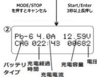
放電が開始されると②の画面が表示され、電圧や放電容量などを確認できます。設定値まで放電を完了するとブザー音が鳴り、放電が終了します。
