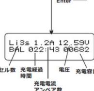
操作チャート図を参考に、①の画面を呼び出します。LiFeの場合はLiFeと表示されます。①の画面でEnterを押すと電流表示が点滅しますので、充電電流を設定してください。リポバッテリは通常1C(3000mAhなら3.0A)での充電を行ないます。(3S)の数字がセル数ですので、充電するバッテリに合わせた設定にしてください。
