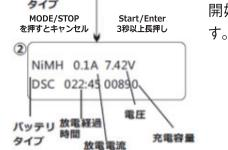
①の画面での設定完了後、Enter長押しで②の画面に切り替わり放電が開始されます。バッテリ種類、放電電流や電圧など放電状況が表示されます。設定値まで電圧が下がるとブザーが鳴り、放電を終了します。
