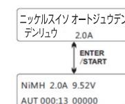
このモードは充電中、充電電流は自動で設定されます。しかし、充電電流の上限を設定すれば、それ以上の電流を流しません。このモードは小さな容量や、低い電気抵抗のニッケル水素バッテリを充電する際役立ちます。このモードはRCのバッテリの使用環境において非常に適した充電モードです。
