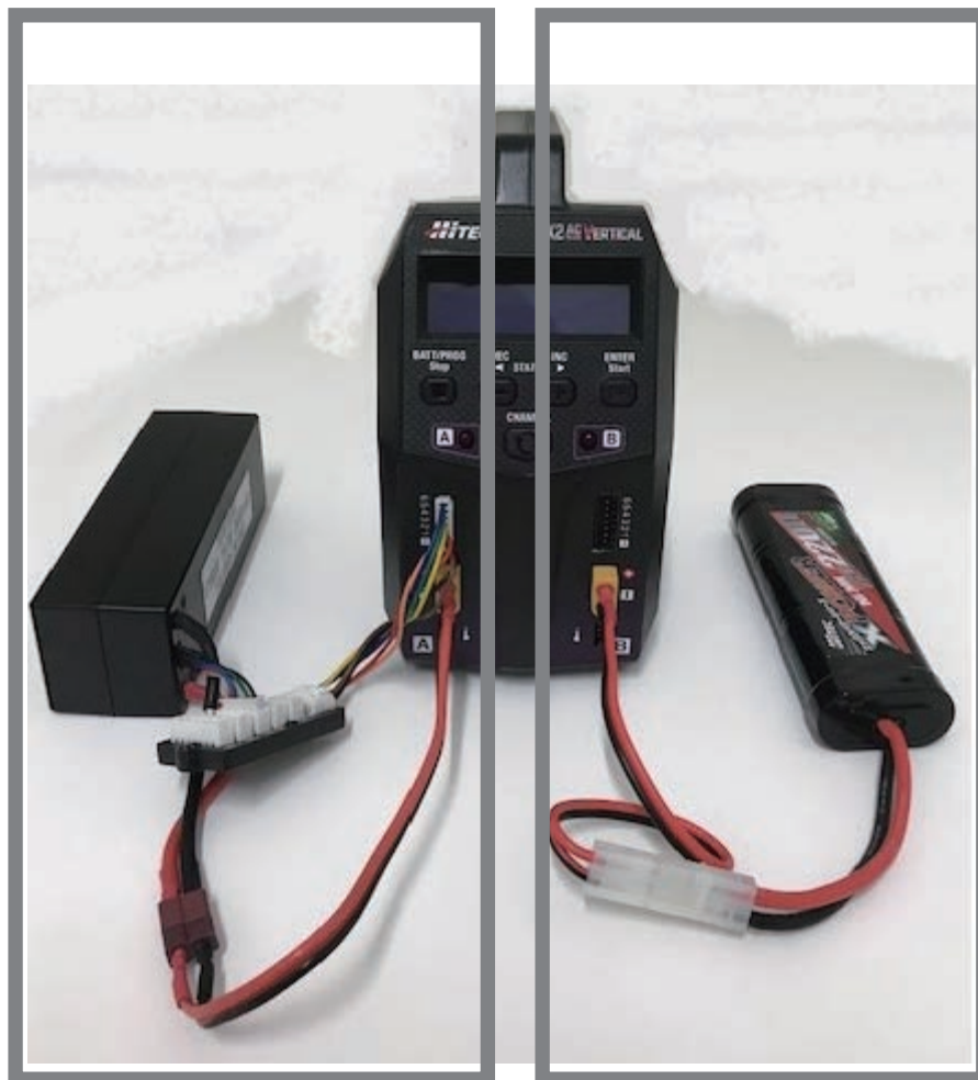
リチウム系バッテリーの接続例
